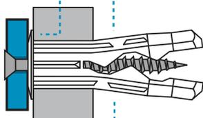
Потайная шляпка шурупа создает аккуратный внешний вид соединения.
